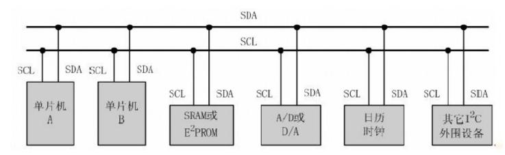
I2C总线通过上拉电阻接正电源。当总线空闲时,两根线均为高电平。连到总线上的任一器件输出的低电平,都将使总线的信号变低,即各器件的SDA及SCL都是线"与"关系。
