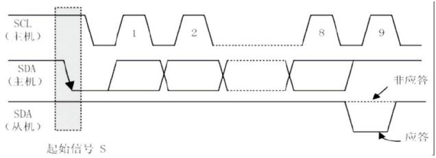
由于某种原因从机不对主机寻址信号应答时(如从机正在进行实时性的处理工作而无法接收总线上的数据),它必须将数据线置于高电平,而由主机产生一个终止信号以结束总线的数据传送。
